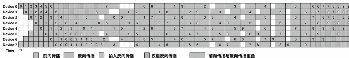
图2-4 基于DualPipe的双向流水线调度机制
