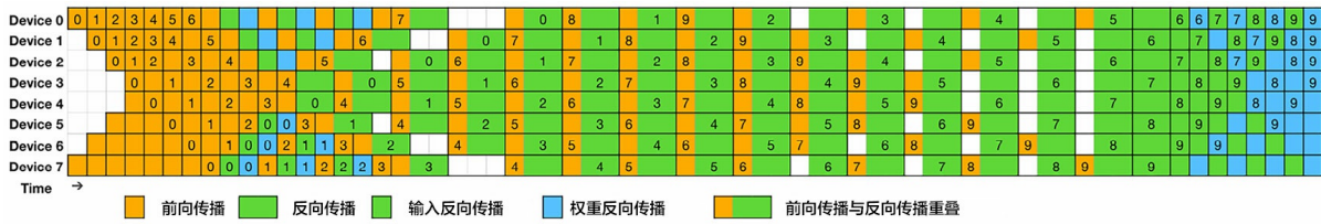
▲ 图2-4 基于DualPipe的双向流水线调度机制
