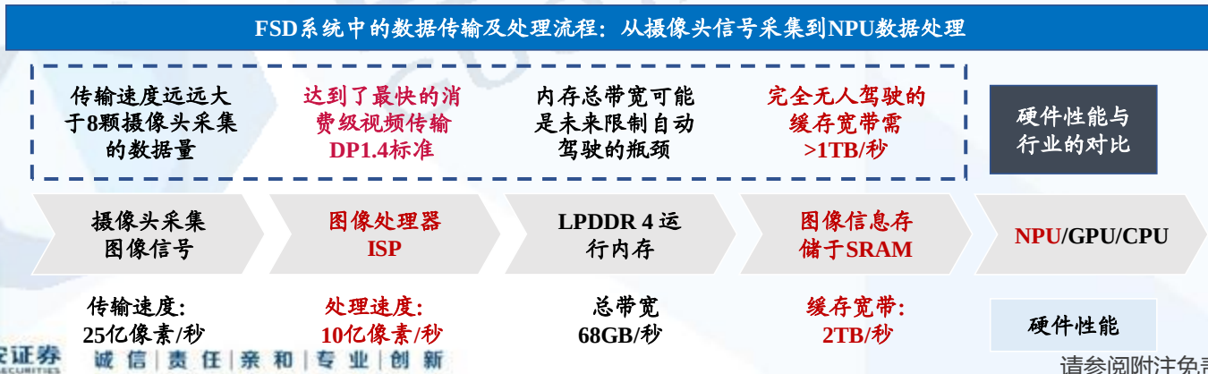
图32：特斯拉FSD芯片的特点主要体现在高速图像处理、NPU、SRAM等三个方面
