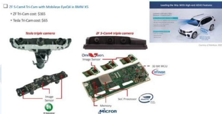
图26：特斯拉的三前摄像头与TriCam比较图
